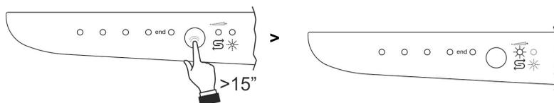
À la suite du réglage ou de l'affichage de celle qui est configurée, il suffit de relâcher le bouton pendant quelques secondes, et le lave-vaisselle se remet automatiquement à l'état standard en quittant le mode réglage.
