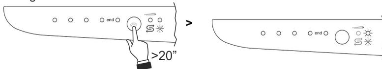
À la suite du réglage ou de l'affichage de celui qui est configuré, il suffit de relâcher le bouton pendant quelques secondes, et le lave-vaisselle se remet automatiquement à l'état standard en quittant le mode réglage.
