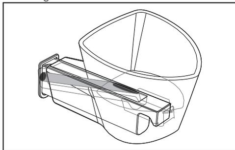
4. Versez la solution de détartrage jusqu'à ce que le voyant de niveau maximum
