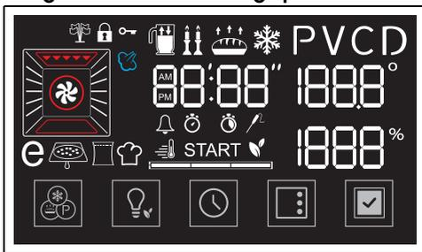
L'afficheur indique les paramètres et les valeurs relatifs à l'opération sélectionnée. Pour l'utiliser, il suffit de tourner les manettes fonctions et température et/ou d'appuyer sur les touches présentes dans la partie basse de l'afficheur, selon les opérations que l'appareil doit effectuer.
