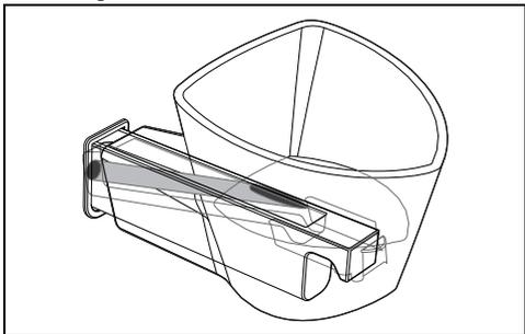
4. Versez l'eau (à l'aide d'une bouteille ou d'un verre doseur) jusqu'à ce que le voyant de niveau maximum s'allume
