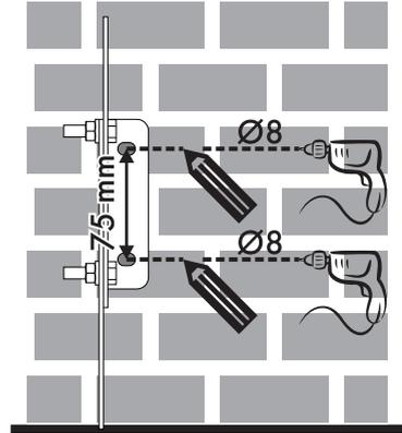
6. Considérez une distance de 50 mm du côté de l'appareil aux trous de la bride.
