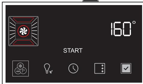
3. Tournez la manette de la température pour sélectionner la température souhaitée (de 50 °C à 250°C).
