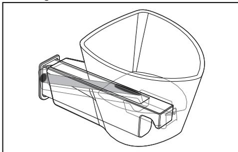
4. Versez l'eau (à l'aide d'une bouteille ou d'un verre doseur) jusqu'à ce que le voyant de niveau maximum s'allume
