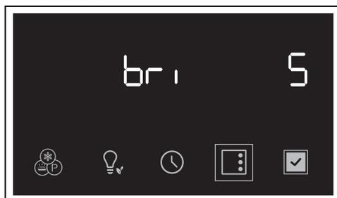
2. Tournez la manette température à droite ou à gauche pour sélectionner la luminosité souhaitée, de la valeur 1 (basse luminosité) à la valeur 5 (haute luminosité).
