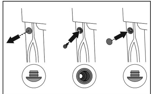
1. Enlevez les bouchons des douilles introduits à l'avant de l'appareil.
