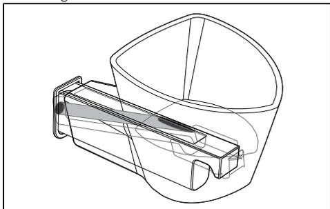
4. Versez la solution détartrante jusqu'à ce que le voyant de niveau maximum s'allume
