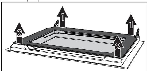
3. Décrochez les axes avant en suivant le mouvement indiqué par les flèches 2.
