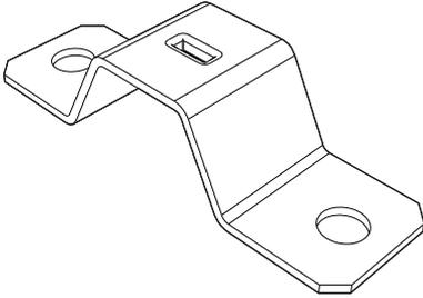
En cas d'utilisation du câble **3 x 10 mm<sup>2</sup>**, le serre-câble en plastique doit être remplacé par le pontet métallique fourni.
