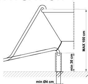
En présence de tuyaux de rallonge disposés horizontalement, pour un maximum de 3 m, placez le tuyau d'évacuation à une hauteur maximale de **85 cm** du sol.
