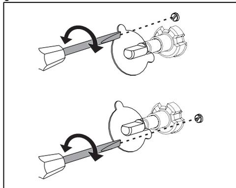
Allumez le brûleur et mettez-le en position minimum. Extrayez la poignée du robinet de gaz et agissez sur la vis de réglage située à côté de la tige du robinet (selon les modèles),
