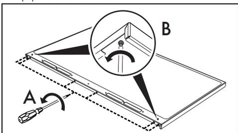
2. Positionnez le dossieret sur la plaque. Faites correspondre les 6 rainures inférieures du dossieret et les 6 vis situées à l'arrière de la plaque desserrées précédemment.
