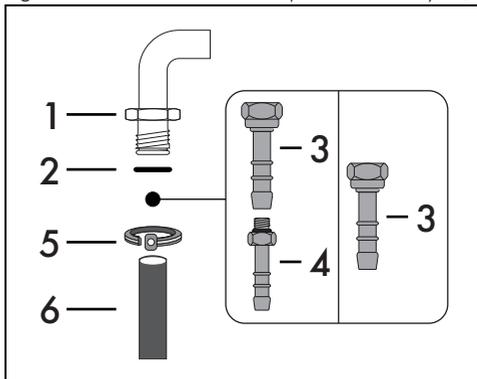
Vissez minutieusement l'embout 3 sur le raccord du gaz 1 (filet 1/2" ISO 228-1) de l'appareil en interposant le joint 2. Suivant le diamètre du tuyau du gaz utilisé, on peut également visser l'embout 4 sur l'embout 3.
