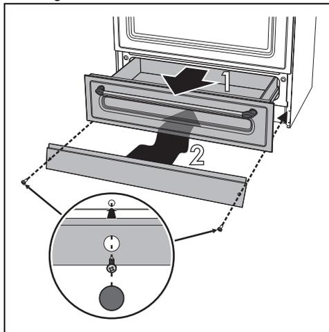
Le socle doit toujours être positionné et correctement fixé sur l'appareil.
