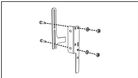
4. Alignez la base du crochet de la bride de fixation sur la base de la coupe de la plaquette de fixation au mur.
