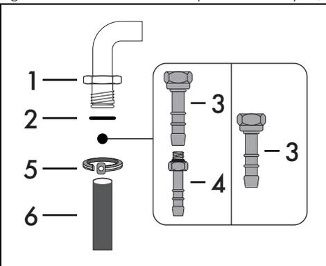
Vissez minutieusement l'embout 3 sur le raccord du gaz 1 (filet 1/2" ISO 228-1) de l'appareil en interposant le joint 2. Suivant le diamètre du tuyau de gaz utilisé, on peut également visser l'embout 4 sur l'embout 3.
