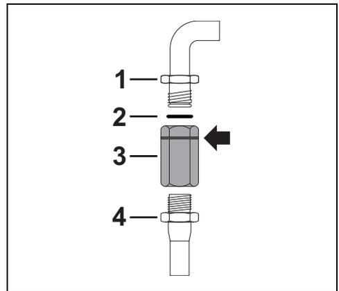
Appliquez du matériau isolant sur le filet du tuyau de gaz 4 avant d'y visser l'adaptateur 3. Vissez le bloc sur le raccord mobile 1 de l'appareil en interposant toujours le joint 2 fourni.
