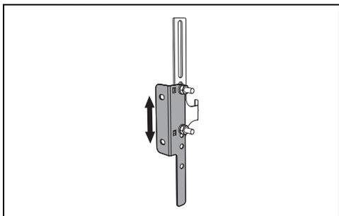
6. Considérez une distance de 50 mm du côté de l'appareil aux trous de la bride.
