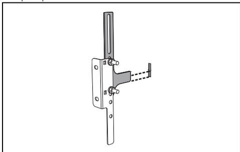
5. Alignez la base de la bride de fixation jusqu'au sol et serrez les vis pour fixer les dimensions.
