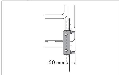
position des trous à réaliser dans le mur.
