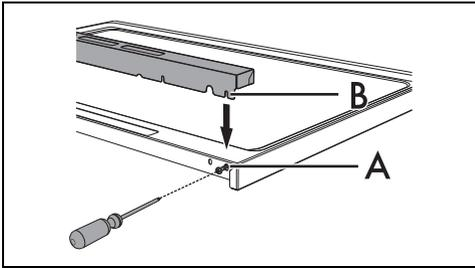
Le dossieret doit toujours être positionné et correctement fixé sur l'appareil.
