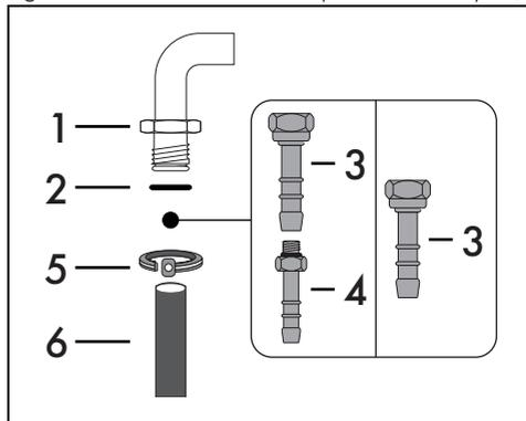
Vissez minutieusement l'embout 3 sur le raccord du gaz 1 (filet 1/2" ISO 228-1) de l'appareil en interposant le joint 2. Suivant le diamètre du tuyau du gaz utilisé, on peut également visser l'embout 4 sur l'embout 3.
