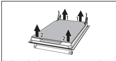
3. Décrochez les axes avant en suivant le mouvement indiqué par les flèches 2.
