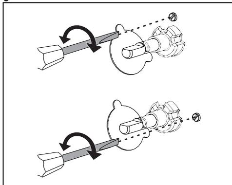
Allumez le brûleur et mettez-le en position minimum. Extrayez la poignée du robinet de gaz et agissez sur la vis de réglage située à côté de la tige du robinet (selon les modèles), jusqu'à obtenir une flamme minimale régulière. Remontez la poignée et vérifiez la stabilité de la flamme du brûleur. Tournez rapidement la poignée du maximum au minimum : la flamme ne doit pas s'éteindre. Répétez cette opération pour tous les robinets de gaz.
