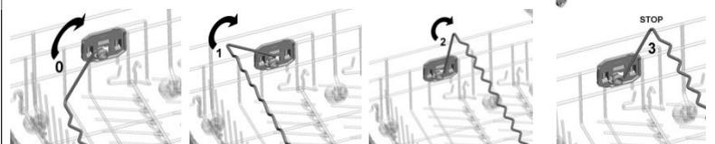
Supports rabattables à 2 positions (1-2). En position 1 (verticale), ils peuvent servir à disposer des assiettes et en position 2 (inclinée) pour y appuyer des verres à pied qui seront maintenus par le **porte-verres** (glass holder). Réglage : soulevez le point **P** comme sur le schéma jusqu'à ce que le support tourne en position 2.
