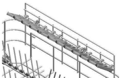
**Porte-verres** (glass holder). Support pour les verres à pied. En le soulevant, il tourne de la position de repos (0) et se bloque en un mouvement sur trois positions différentes (1-2-3).
