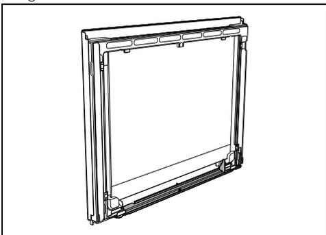
4. Après le nettoyage, repositionnez la vitre interne dans les pattes. Veillez à centrer et à encastrer les 4 pivots dans leurs logements sur la porte, aidez-vous des joints placés à
