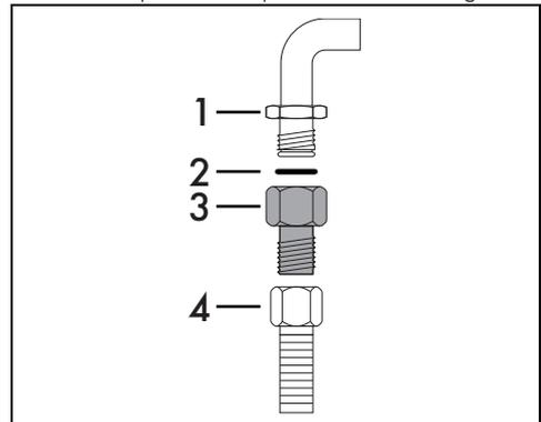
Vissez soigneusement le raccord 3 au raccord du gaz 1 (fileté 1/2" ISO 228-1) de l'appareil en interposant toujours le joint 2 fourni. Appliquez du matériau isolant sur le filet du raccord 3, puis vissez le tuyau flexible en acier 4 au raccord 3.
