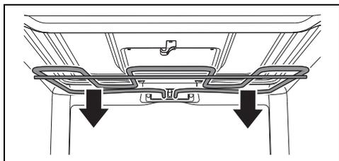
3. Au terme des opérations de nettoyage, remettez la résistance en place et tournez l'arrêt pour l'enclencher.
