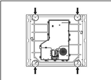
2. Vissez les pattes de fixation (A) dans les trous indiqués au moyen des vis enlevées
