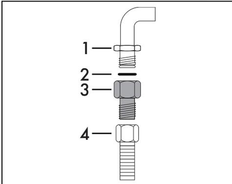
Vissez soigneusement le raccord 3 au raccord du gaz 1 (fileté 1/2" ISO 228-1) de l'appareil en interposant toujours le joint 2 fourni. Appliquez du matériau isolant sur le filetage du raccord 3, puis vissez le tuyau flexible en acier 4 au raccord 3.
