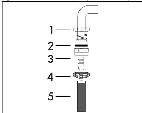
Vissez minutieusement l'embout 3 sur le raccord du gaz 1 (filet 1/2" ISO 228-1) de l'appareil en interposant le joint 2. Après avoir vissé l'embout, introduisez le tuyau du gaz 5 sur celui-ci et fixez-le avec le collier 4 conforme à la norme en vigueur.
