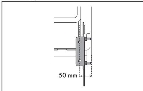
7. Déplacez la bride sur le mur et marquez la position des trous à réaliser dans le mur.
