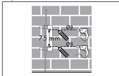
8. Après avoir réalisé les trous dans le mur, utilisez des chevilles avec des vis pour fixer la bride sur le mur.
