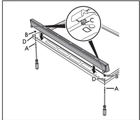
Le dossieret doit toujours être positionné et correctement fixé sur l'appareil.
