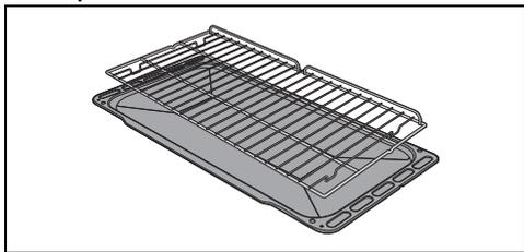
Introduisez la grille pour lèche-frite à l'intérieur de la lèche-frite. On peut ainsi recueillir les graisses séparément des aliments en train de cuire.
