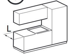
Tuyaux passant sous la plinthe, **épaisseur minimale de la plinthe 100mm**
