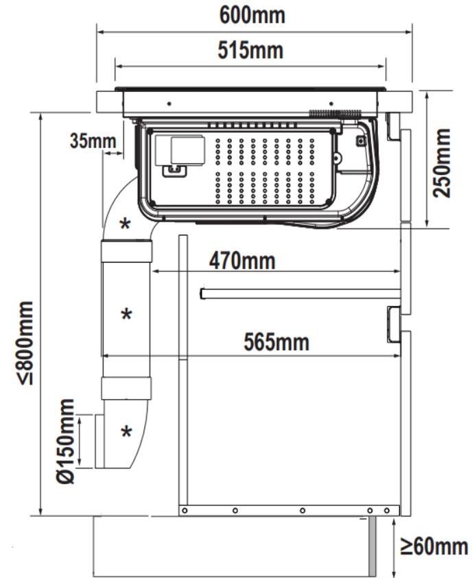
Tuyaux **NE** passent **PAS** sous la plinthe, **épaisseur minimale de la plinthe 60mm**
