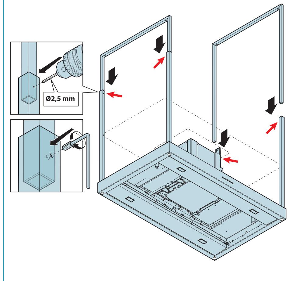
**IT** - Installazione valvola di non ritorno (10); montaggio tubo d'aspirazione (11); assemblaggio camino (12).
