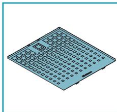
Fedtfilterne af metal tilbageholder fedtpartiklerne: Sidstnævnte, som aflejret på filterne, kan nære eventuelle flammer i forbindelse med tilberedning af maden, de udvikler en ubehagelig lugt og påvirker luftpassagen så emhættens sugeevne reduceres. Af samme årsager bør man **ofte vaske** metalfilterne (**mindst en gang om måneden**). Lad dem stå i blød i cirka 1 time i kogende varmt vand og opvaskemiddel uden at bukke dem. Anvend aldrig ætsende, syrlige eller alkaliske rengøringsmidler.
