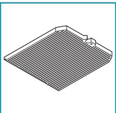
Aktiivihiilisuodattimien tehtävänä on pidättää niiden läpi virtaavan ilman hajuja: puhdistettu ilma palautetaan keittiön suodattimien läpi menon jälkeen.
