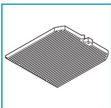
Os filtros de carvão ativado têm a função de reter os odores presentes no fluxo de ar: o ar depurado para as sucessivas passagens através dos filtros é inserida na cozinha.
