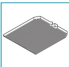
Los filtros de carbón activo tienen la función de retener los olores presentes en el flujo de aire que los atraviesa: el flujo de aire que los atraviesa: el aire depurado mediante los pasajes a través de los filtros se vuelve a introducir en el ambiente de la cocina.
