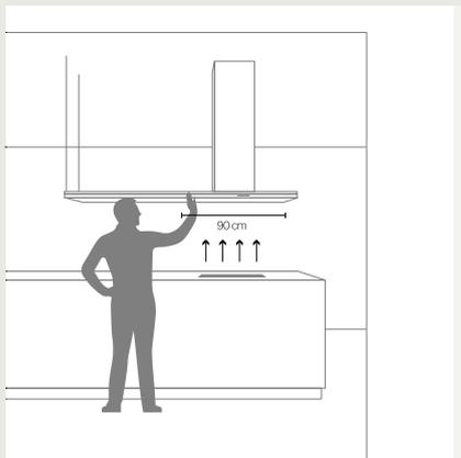
Exemple modèle droite. La surface d'aspiration et les commandes se trouvent sur le côté droit lorsque vous êtes devant l'unité.
