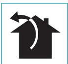
In deze versie wordt de rook en damp via een afvoerbus naar buiten afgevoerd. Hiervoor moet de uitlaatfitting van de kap via een buis met een externe uitgang aangesloten worden.
