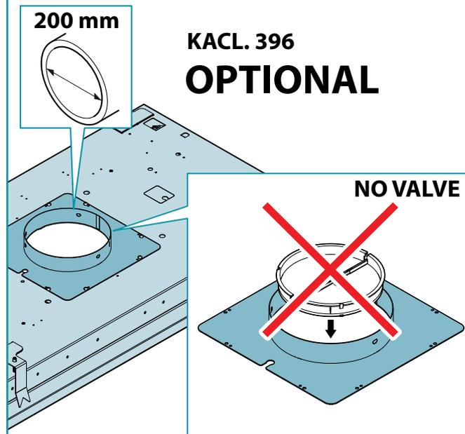
IT - Fissaggio tubo di aspirazione (3).
