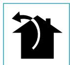
Nessa versão, fumos e vapores são direcionados para o exterior através do tubo de descarga. Para isso, a conexão de saída do exaustor deve estar ligada através de um tubo a uma saída externa.
