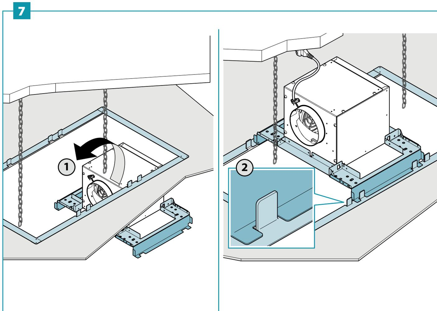
IT - Montaggio tubo d'aspirazione e collegamento elettrico (8).
