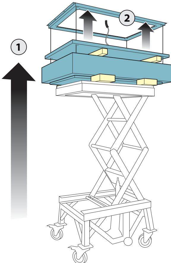
IT - Fissaggio staffa di fissaggio a soffitto (2). Installazione soffitto in cemento armato (A), Installazione con soffitto in laterizio (B).
