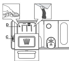
**Pour ouvrir le distributeur de détergent, utilisez le dispositif d'ouverture C. Insérez le détergent dans le distributeur sec D seulement. Placez la quantité de détergent pour le pré-lavage directement dans la cuve.**
