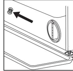
Retirer le bouchon du « tuyau d'évacuation d'urgence » de l'extrémité du tuyau et laisser l'eau s'écouler dans le récipient.
