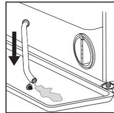
3. Faire tourner la poignée du filtre d'évacuation et le sortir du logement. Une fois que le récipient est rempli d'eau, remettre le bouchon à l'extrémité du tuyau et réinsérer le petit tuyau dans la base du lave-linge. Ensuite, vider le récipient.
