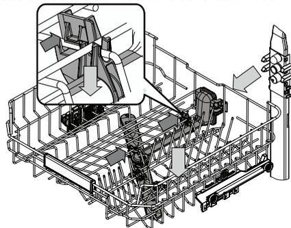
À l'occasion, des résidus de nourriture s'incrustent dans les bras d'aspersion et bloquent les trous utilisés pour asperger de l'eau. Il est donc conseillé de vérifier les bras de temps en temps et de les nettoyer avec une petite brosse non métallique.
