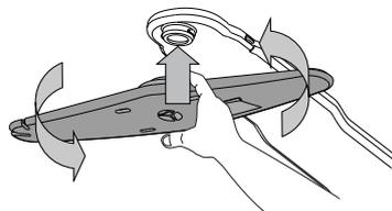
Le bras d'aspersion supérieur se démonte en le tirant vers le bas, tout en le tournant dans le sens inverse des aiguilles d'une montre.
