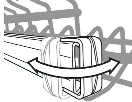
Ouvrir les butées installées à droite et à gauche et sortir le panier.
