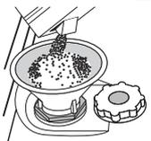
4. Enlevez l'entonnoir et essuyez les résidus de sel autour de l'ouverture. Assurez-vous que le bouchon est bien serré pour éviter que du détergent pénètre dans le réservoir durant le cycle de lavage (le réservoir pourrait s'endommager au point de ne plus être réparable).
