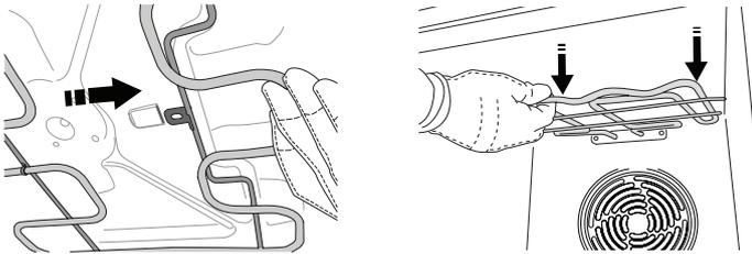
**2.** Pour replacer l'élément chauffant, soulevez-le, tirez légèrement vers l'avant, et assurez-vous que l'onglet de soutien est dans son appui.
