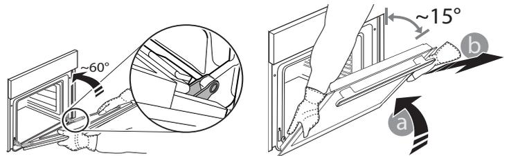
**3.** Réinstallez la porte en la plaçant devant le four pour aligner les crochets des charnières avec leurs appuis et attacher la partie supérieure sur son appui.
