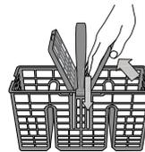
Le panier comprend des grilles supérieures pour placer les couverts plus facilement. Le panier à couvert doit uniquement être placé à l'avant du panier inférieur.
