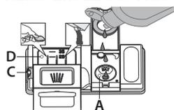
Le liquide de rinçage permet à la vaisselle de SÉCHER plus facilement. Le distributeur de liquide de rinçage **A** devrait être rempli lorsque le **voyant de NIVEAU DE LIQUIDE DE RINÇAGE**
