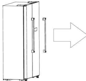
3. Une fois l'appareil en place, remettez les poignées en place en suivant la procédure en sens inverse.
