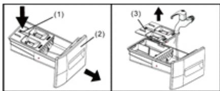
1. Ouvrez complètement le bac à produits lessiviels. Appuyez sur le loquet du tiroir (1) et tirez sur le bac (2) pour le sortir de l'appareil.
