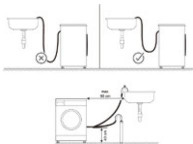
2. Raccordez le flexible à une hauteur minimale de 40 cm et une hauteur maximale de 90 cm.
