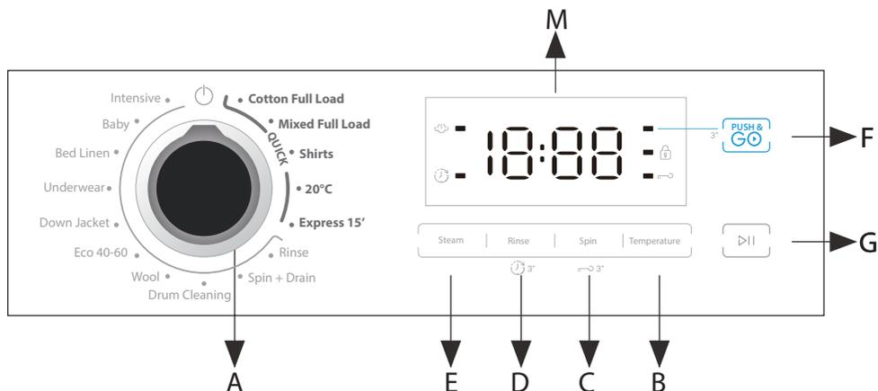
**A---SÉLECTEUR DE CYCLE DE LAVAGE** : ce bouton sert à sélectionner le cycle de lavage souhaité (voir « Tableau des cycles de lavage »).
