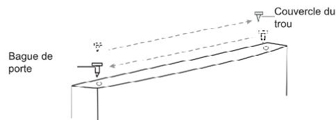
15. Retirez le bouchon du trou de vis de la charnière centrale sur le côté gauche de l'armoire, puis installez-le dans les trous de vis sur le côté droit de l'armoire.
