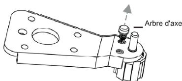
9. Insérez l'arbre de l'axe dans le trou gauche de la charnière inférieure, puis fixez l'arbre avec la rondelle et l'écrou.
