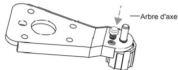
10. Installez la charnière inférieure sur le côté gauche de l'armoire.
