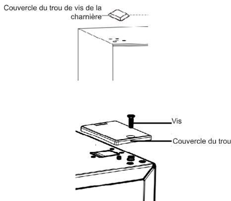
21. Fixez la charnière supérieure au côté supérieur gauche de l'armoire à l'aide des trois vis que vous avez retirées précédemment. Avant de serrer les vis de la charnière supérieure, assurez-vous que le haut de la porte est de niveau avec le meuble et que le joint en caoutchouc assure une bonne étanchéité.
