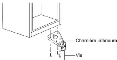
8. Retirez la rondelle et l'écrou qui fixent l'arbre de l'axe au trou droit de la charnière inférieure, puis retirez l'arbre.
