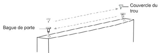
20. Retirez le couvercle de l'orifice en haut à gauche. (Pour les produits dotés d'un trou carré sur le côté droit du réfrigérateur, vous devez également retirer le couvercle du trou et les vis dans le petit sac d'accessoires et les fixer dans le coin supérieur droit)
