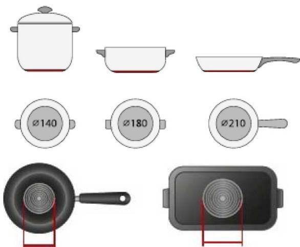
5. Si la partie ferromagnétique ne couvre que partiellement le fond de la casserole, seule la zone ferromagnétique chauffera, le reste du fond peut ne pas atteindre une température suffisante pour la cuisson.
