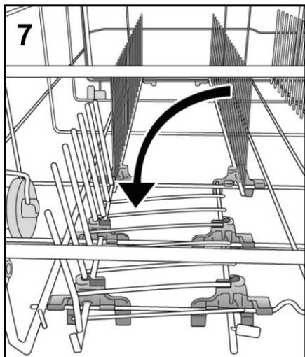
**Pour positionner correctement le panier à couverts, baissez les picots rabattables avant comme cela est montré sur la fig. 7 pour garantir une stabilité maximale.**
