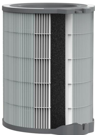
H-TRIFILTER intègre trois couches de filtration d'air en une seule, pour une performance supérieure de purification de l'air. Il élimine jusqu'à 99,97 % des pneumallergènes de taille allant jusqu'à 0,3 µm. Une fois que les pollens sont capturés par H-TRIFILTER, ils sont inactivés (\*) pour atténuer votre réaction allergique.
