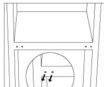
7. Posez l'arrière de l'appareil sur une surface rembourrée. Dévissez la charnière inférieure et le pied de nivellement.
