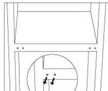
11. Relevez l'appareil et placez la porte sur la charnière inférieure. Assurez-vous que le noyau de charnière inférieur est inséré dans le trou de porte. Déplacez ensuite le cache du trou de charnière de la porte inférieure de gauche à droite..
