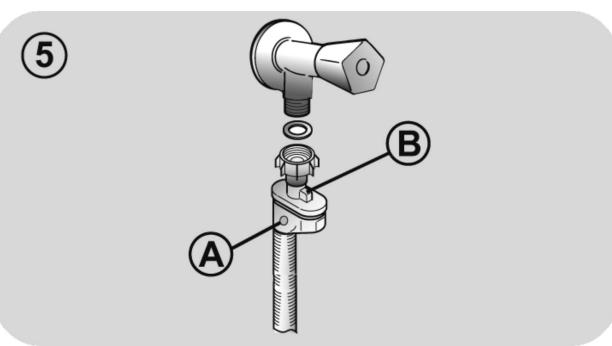
● **AQUAPROTECT - TUBO DI CARICO CON PROTEZIONE** (fig. 6): in caso di perdita d'acqua dal tubo primario interno "A", la guaina di contenimento trasparente "B" conterrà l'acqua, permettendo di terminare il lavaggio. Finito il ciclo, sostituire il tubo di carico contattando il Centro Assistenza Tecnica.
