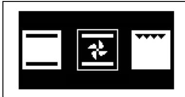
Per passare al menu strumenti di cottura scegliere la temperatura desiderata girando la manopola termostato, dopo un timeout fisso di circa 3/4 secondi verrà confermato il valore selezionato e sul display apparirà la schermata di stato.
