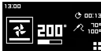
La sonda funziona misurando la temperatura all'interno di un pezzo di carne. Non ci sono da impostare tempi di cottura, ciò dipende da quanto tempo ci vuole alla temperatura interna della carne per raggiungere la temperatura impostata. Questo può variare a seconda del peso e del tipo di carne. Per questo motivo non è raccomandato che la sonda sia utilizzata con il timer automatico.
