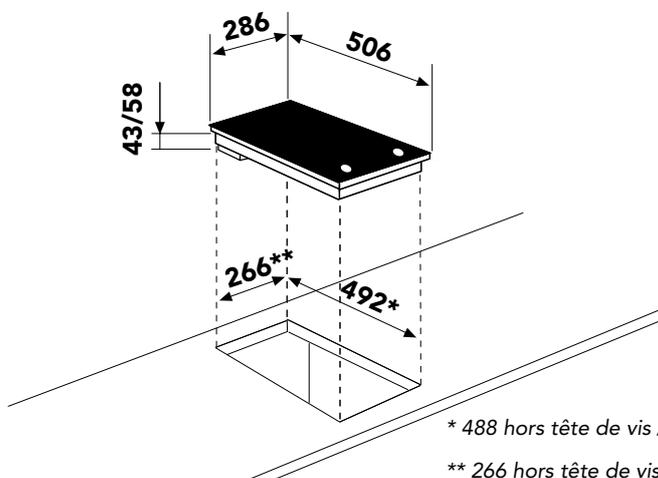
\* 488 hors tête de vis / 492 sans tolérance montage mécanique / 495 avec tolérance montage.
