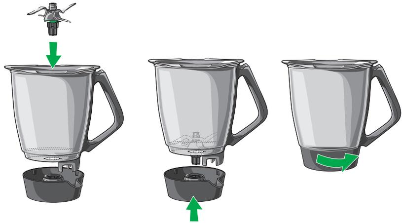
1. Assurez-vous que le joint d'étanchéité de l'ensemble couteaux soit fixé correctement sous la base des couteaux et qu'il l'épouse bien.
