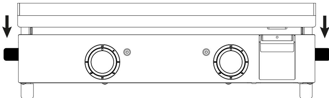
Pour toute installation de la plancha sur un support autre que le chariot, il faut impérativement fixer les éléments sur les côtés du châssis afin d'éviter tout contact avec une paroi latérale.
