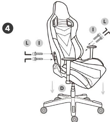
Setzen Sie den Kolben (D) in das Mechanikgehäuse (C) ein. Befestigen Sie die Rückenlehne (A) mit 4 Schrauben M8×25mm (I) am Sitz (B).
