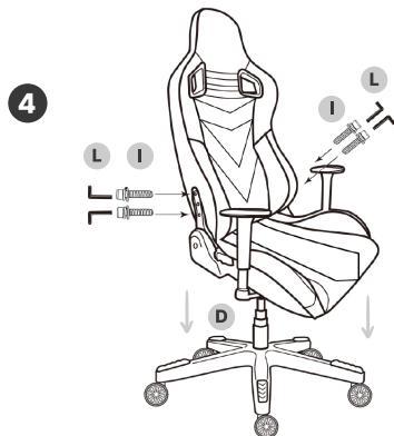
Inserta el pistón (D) en el alojamiento del mecanismo (C). Fija el respaldo (A) al asiento (B) con 4 tornillos M8x30mm (I).
