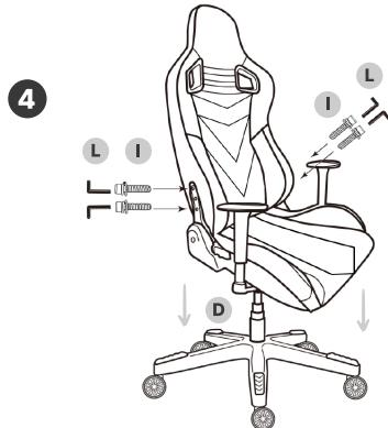
Inserire il pistone (D) nell'alloggiamento del meccanismo (C). Fissare lo schienale (A) al sedile (B) con 4 viti M8×25mm (I).
