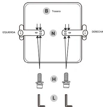
Identifica los brazos izquierdo y derecho (N) e instala cada uno en su lado correspondiente de la base del asiento (B) con 6 tornillos M8X20mm (H).
