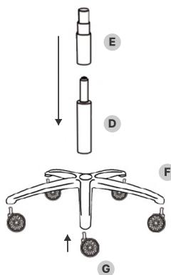
Emboîtez les roues (G) sur la base (F). Puis placer le piston (D) dans le logement de la base (F) et placez le couvercle par-dessus (E).
