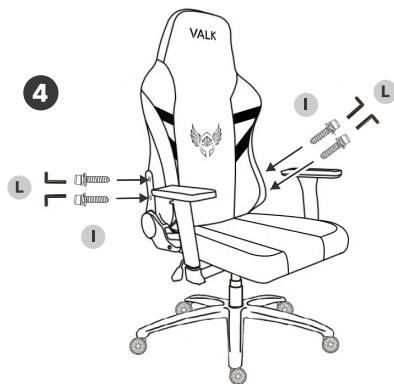
Setzen Sie den Kolben (D) in das Mechanikgehäuse (C) ein. Befestigen Sie die Rückenlehne (A) mit 4 Schrauben M8×25mm (I) am Sitz (B).
