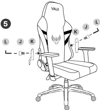
Identificare le coperture laterali destra e sinistra (K) e installare ciascuna sul lato corrispondente dello schienale (A) utilizzando 2 viti M5×8mm (J).
