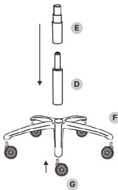
Rasten Sie die Räder (G) in den Sockel (F) ein. Setzen Sie dann den Kolben (D) in das Grundgehäuse (F) und legen Sie den Deckel (E) auf.
