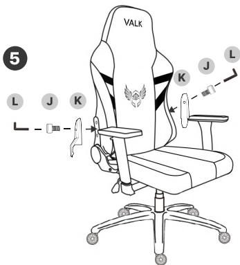
Identifica las tapas laterales (K) izquierda y derecha e instala cada una en su lado correspondiente del respaldo (A) usando 2 tornillos M5×8mm (J).
