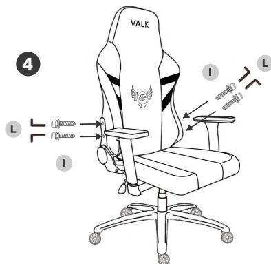
Fija el respaldo (A) al asiento (B) usando 4 tornillos M8×25mm (I).
