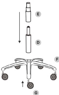
Fija las ruedas (G) a presión en la base (F). Luego coloca el pistón (D) en el alojamiento de la base (F) y coloca encima la cubierta (E).
