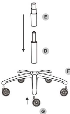
Far scattare le ruote (G) sulla base (F). Poi mettete il pistone (D) nell'alloggiamento della base (F) e mettete il coperchio (E) sopra.
