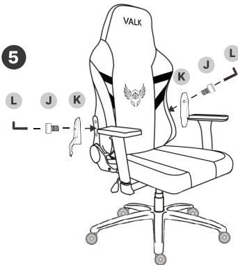
Identifizieren Sie die linke und rechte Seitenabdeckung (K) und montieren Sie jede auf der entsprechenden Seite der Rückenlehne (A) mit 2 Schrauben M5×8mm (J).
