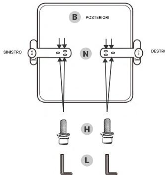
Identificare i braccioli destro e sinistro (N) e installare ciascuno sul lato corrispondente della base del sedile (B) con 6 viti M8×20mm (H).
