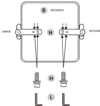
Identifizieren Sie die linke und rechte Armlehne (N) und montieren Sie jede auf der entsprechenden Seite der Sitzbasis (B) mit 6 Schrauben M8x20mm (H).
