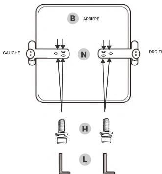
Identifiez les accoudoirs gauche et droit (N) et installez chacun d'eux sur le côté correspondant de la base du siège (B) à l'aide de 6 vis M8X20mm (H).
