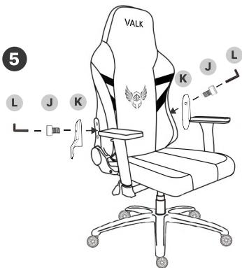
Identifiez les couvertures latérales gauche et droite (K) et installez chacune d'elles sur le côté correspondant du dossier (A) à l'aide de 2 vis M5×8mm (J).
