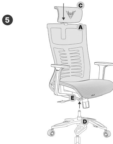
Inserire il pistone (D) nell'alloggiamento del meccanismo (E). Inserire il poggiatesta (C) nella fessura corrispondente nella parte superiore dello schienale (A).
