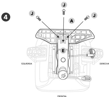
Coloca la parte inferior del respaldo (A) en la parte trasera del mecanismo (E) instalado previamente y fíjalo con 3 tornillos M8x25mm (J).
