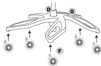
Inserire le ruote (F) nella base (G). Posizionare quindi il pistone (D) nell'alloggiamento della base (G).
