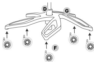
Fija las ruedas (F) a presión en la base (G). Luego coloca el pistón (D) en el alojamiento de la base (G).
