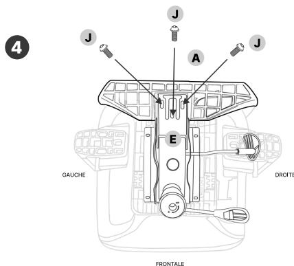
Placez la partie inférieure du dossier (A) à l'arrière du mécanisme précédemment installé (E) et fixez-la à l'aide de 3 vis M8×25mm (J).
