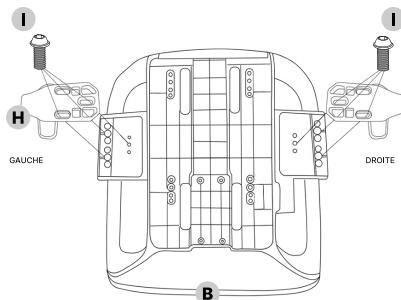
Identifiez les accoudoirs gauche et droit (H) et fixez chacun d'eux sur le côté correspondant de la base du siège (B) à l'aide de 6 vis M6X30mm (I).
