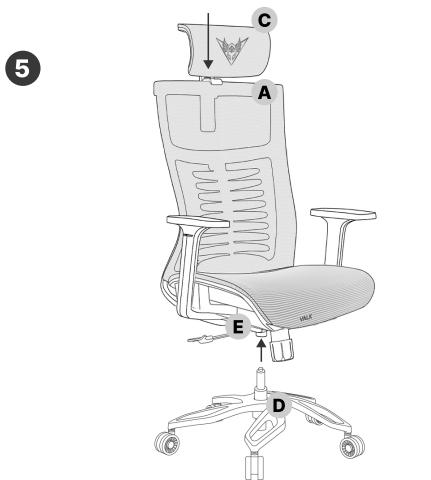
Inserta el pistón (D) en el alojamiento del mecanismo (E). Instala el reposacabezas (C) a presión en la ranura correspondiente situada en la parte superior del respaldo (A).
