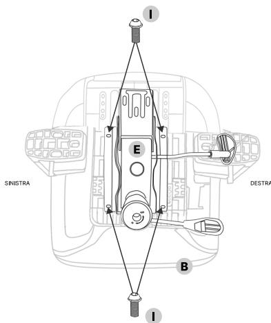
Posizionare il meccanismo (E) sulla base del sedile (B) con la rotella di regolazione rivolta verso la parte frontale. Far coincidere i fori del meccanismo con le filettature preinstallate nel sedile e fissarlo con 4 viti M6×30 mm (I).
