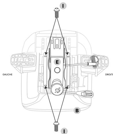
Placer le mécanisme (E) sur la base du siège (B) avec la molette de réglage tournée vers l'avant. Faites correspondre les trous du mécanisme avec les filets préinstallés dans le siège et fixez-le avec 4 vis M6×30mm (I).
