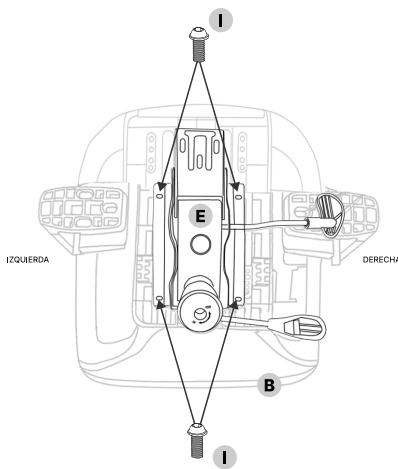
Coloca el mecanismo (E) en la base del asiento (B) con la rueda de ajuste orientada hacia la parte delantera. Haz coincidir los orificios del mecanismo con las roscas preinstaladas en el asiento, y fíjalo con 4 tornillos M6×30mm (I).
