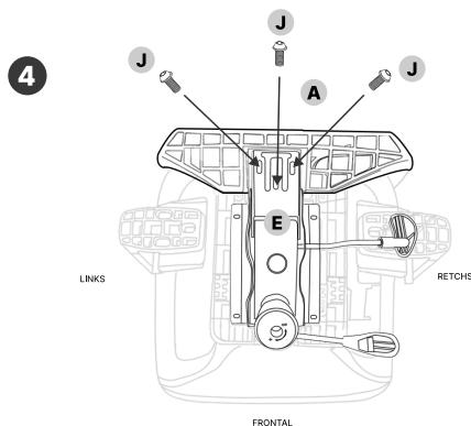
Setzen Sie den unteren Teil der Rückenlehne (A) auf die Rückseite des zuvor installierten Mechanismus (E) und befestigen Sie ihn mit 3 Schrauben M8x25mm (J).
