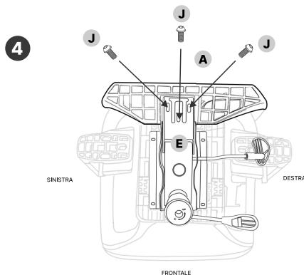
Posizionare la parte inferiore dello schienale (A) sul retro del meccanismo precedentemente installato (E) e fissarlo con 3 viti M8×25 mm (J).
