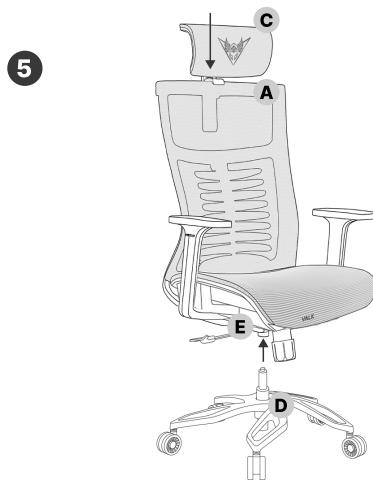
Insérer le piston (D) dans le boîtier du mécanisme (E). Enclenchez l'appuie-tête (C) dans la fente correspondante en haut du dossier (A).
