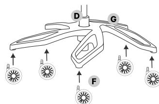
Enclencher les roues (F) dans la base (G). Placez ensuite le piston (D) dans le logement de la base (G).
