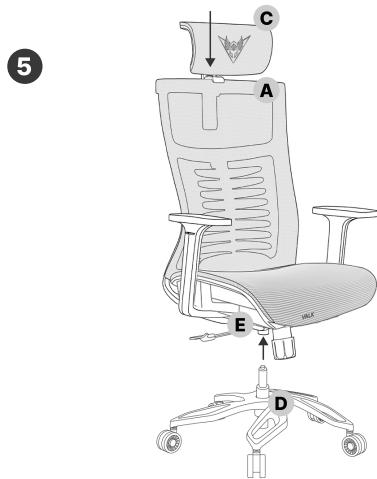
Setzen Sie den Kolben (D) in das Mechanismusgehäuse (E) ein. Rasten Sie die Kopfstütze (C) in den entsprechenden Schlitz an der Oberseite der Sitzlehne (A) ein.
