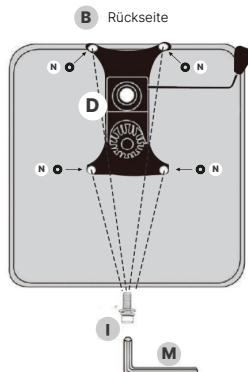
Legen Sie die 4 Nylon-Unterlegscheibe (N) über die Löcher in der Sitzbasis (B). Montieren Sie den Mechanismus (D) mit 4 Schrauben M8×20mm (I) an der Sitzbasis (B), wobei der Hebel zur Rückseite des Sitzes zeigt. Sobald der Sitz montiert ist, bedienen Sie ihn mit der rechten Hand.
