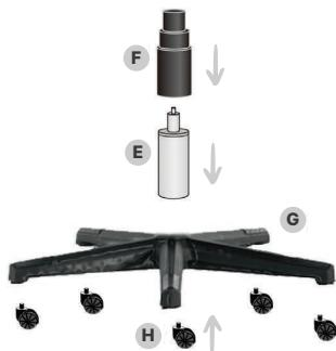
Rasten Sie die Räder (H) auf den Sockel (G). Setzen Sie dann den Kolben (E) in das Grundgehäuse (G) und legen Sie den Deckel (F) auf.
