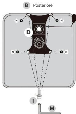
Posizionare le 4 rondelle di nylon (N) sui fori della base del sedile (B). Installare il meccanismo (D) nella base del sedile (B) con 4 viti M8×20mm (I), con la leva rivolta verso il retro del sedile. Una volta che il sedile è montato, lo azionerete con la mano destra.
