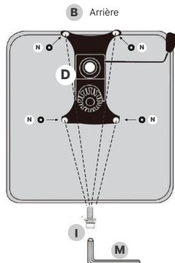
Placez les 4 rondelles en nylon (N) sur les trous de la base du siège (B). Installez le mécanisme (D) sur la base du siège (B) avec 4 vis M8×20mm (I), avec le levier tourné vers l'arrière du siège. Une fois le siège monté, vous le manipulerez avec votre main droite.
