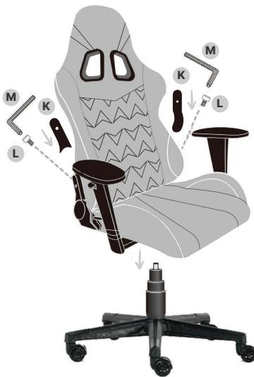
Inserire il pistone (E) nell'alloggiamento del meccanismo (D) e montare i 2 coperchi laterali (K) utilizzando 2 viti M5×8mm (L).
