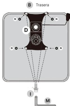
Coloca las 4 arandelas de nylon (N) sobre los agujeros en la base del asiento (B). Instala el mecanismo (D) en la base del asiento (B) con 4 tornillos M8×20mm (I), con la palanca orientada hacia la parte trasera del asiento. Una vez montada la silla la accionarás con la mano derecha.
