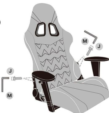
Fissare lo schienale (A) al sedile (B) usando 4 viti M8×25mm (J).
