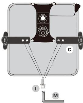
Identificare i braccioli destro e sinistro (C) e installare ciascuno sul lato corrispondente della base del sedile (B) utilizzando 4 viti M8X20mm (I).
