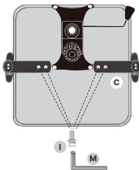
Identifica los brazos izquierdo y derecho (C) e instala cada uno en su lado correspondiente de la base del asiento (B) usando 4 tornillos M8X20mm (I).
