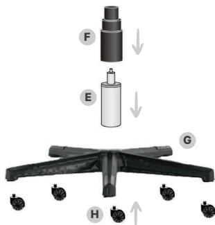
Fija las ruedas (H) a presión en la base (G). Luego coloca el pistón (E) en el alojamiento de la base (G) y coloca encima la cubierta (F).
