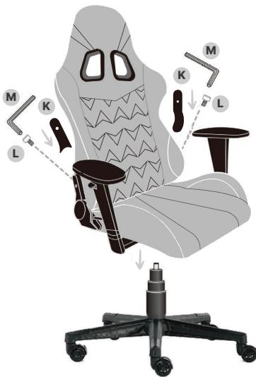
Setzen Sie den Kolben (E) in das Mechanikgehäuse (D) ein und montieren Sie die 2 seitlichen Abdeckungen (K) mit 2 Schrauben M5×8mm (L).
