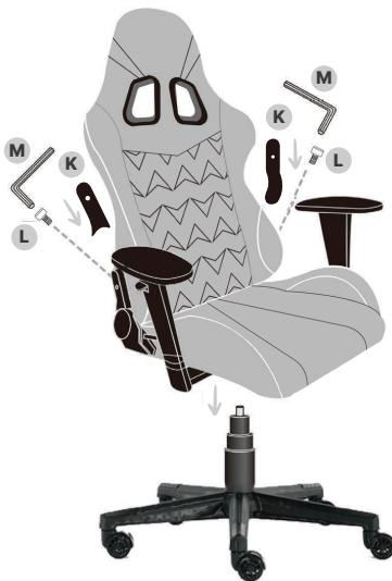
Insérez le piston (E) dans le logement du mécanisme (D) et montez les 2 couvercles latéraux (K) à l'aide de 2 vis M5×8mm (L).
