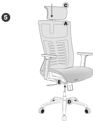
Inserta el pistón (D) en el alojamiento del mecanismo (E). Instala el reposacabezas (C) a presión en la ranura correspondiente situada en la parte superior del respaldo (A).
