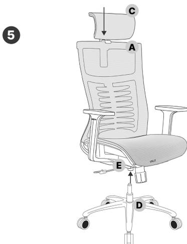
Insérer le piston (D) dans le boîtier du mécanisme (E). Enclenchez l'appui-tête (C) dans la fente correspondante en haut du dossier (A).
