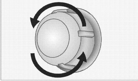
3. Si la lampe de votre four est de type (A) comme l'indique le schéma ci-après, ôtez-la en la faisant pivoter comme illustré, avant de la remplacer.
