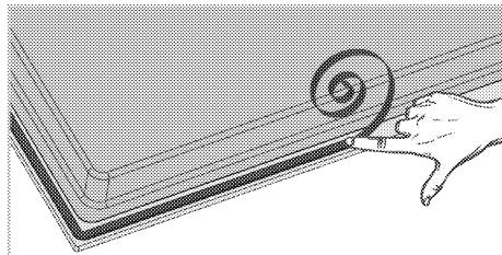
4. Fixez les ressorts de montage en les insérant et en les vissant à travers les orifices du boîtier inférieur tel qu'illustré dans la figure.
