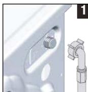
1. Raccordez le tuyau spécial fourni avec la machine aux vannes d'arrivée d'eau de la machine
