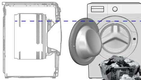
Dans le programme lavage 5 kg et séchage 5 kg il est recommandé de charger la machine jusqu'au niveau indiqué ci-dessus pour des conditions de séchage idéales (vous pouvez voir la flèche de niveau si vous ouvrez la porte de chargement).
