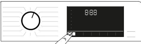
Chaque fois qu'un nouveau programme est sélectionné, la température recommandée pour ce programme apparaît sur l'indicateur de température. Il est possible que la température recommandée ne soit pas la valeur maximale pouvant être sélectionnée pour le programme pertinent. Appuyez de nouveau sur la touche Réglage de la température pour modifier la température.
