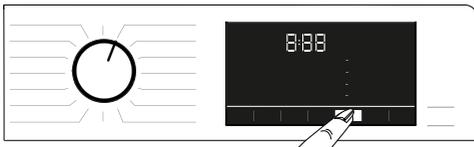
Lorsque vous sélectionnez un nouveau programme de lavage, appuyez sur le bouton de sélection de fonction auxiliaire pour régler l'option de séchage appropriée pour ce programme.
