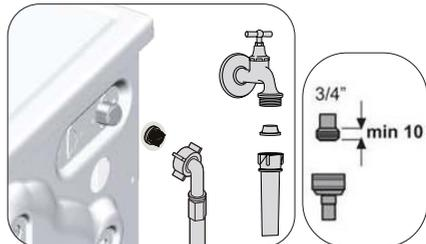
Un filtre se trouve à l'extrémité de chaque vanne d'arrivée d'eau, située au dos de la machine et à l'extrémité de chaque tuyau d'admission d'eau, où ils sont raccordés au robinet. Ces filtres empêchent les corps étrangers et la saleté qui se trouve dans l'eau de pénétrer dans le lave-linge. Les filtres doivent être nettoyés lorsqu'ils sont sales.
