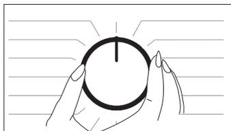
Le programme sera annulé si le bouton de sélection du programme est commuté sur un autre programme ou si la machine est mise hors et en service avec ce bouton.
