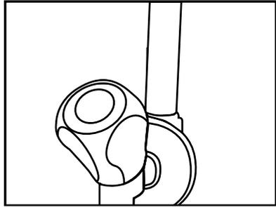
4. Fixez le tuyau d'eau en le tirant du dessus du filtre jusqu'à l'adaptateur de raccordement d'eau du réfrigérateur (voir Section 3.6).
