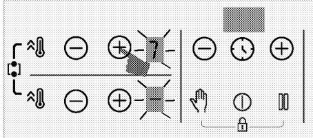
» Pour changer la température, appuyez sur les touches "⊖"/"⊕" du foyer arrière gauche et réglez la température souhaitée.
