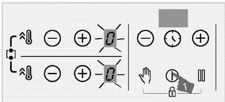
**i** La placa regresará automáticamente al modo en espera, si no se realiza ninguna operación en el plazo de 10 segundos.
