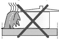
Los derramamientos pueden dañar la superficie vitrocerámica y causar incendios.
