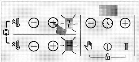
» Para cambiar la temperatura, toque las teclas " $\ominus$ "/" $\oplus$ " de la zona de cocción trasera izquierda y ajuste la temperatura que deseé.
