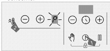
» Le foyer sélectionné fonctionne à la puissance maximale et le symbole « P » s'affiche sur son écran. La zone de cuisson quitte la fonction Booster et continue de fonctionner au niveau « 9 ».
