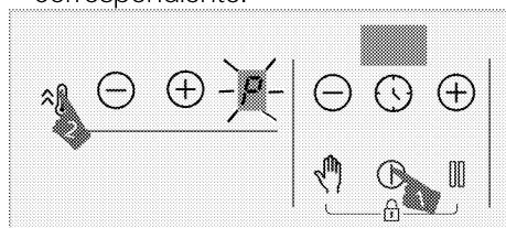
» La zona de cocción seleccionada funcionará a máxima potencia y el símbolo "P" aparecerá en el visor de la zona de cocción. La función de refuerzo se desactiva para la zona de cocción y esta sigue funcionando al nivel "9".
