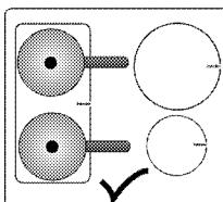
Vous pouvez utiliser les deux moiti's du foyer à grande surface s'par'ment, notamment le foyer arrière gauche et le foyer avant gauche. L'emplacement de la zone de cuisson à grande surface peut varier en fonction du modèle de produit.
