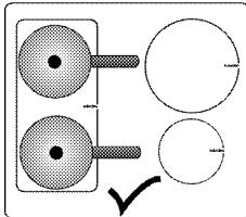
Puede dividir la zona de cocción combinada en dos mitades independientes (trasera izquierda y delantera izquierda). La ubicación de la zona de cocción de superficie amplia puede variar según el modelo del producto.
